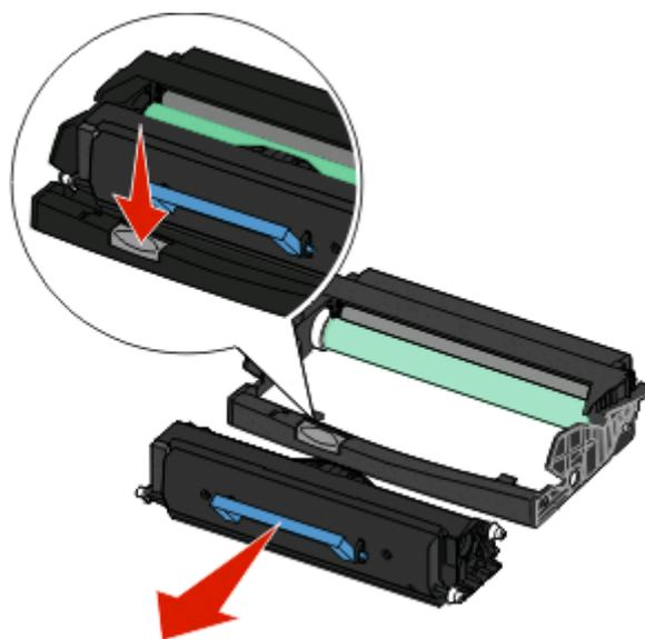
4 Disimballare il nuovo kit del fotoconduttore. Fare attenzione a non toccare il tamburo del fotoconduttore.
